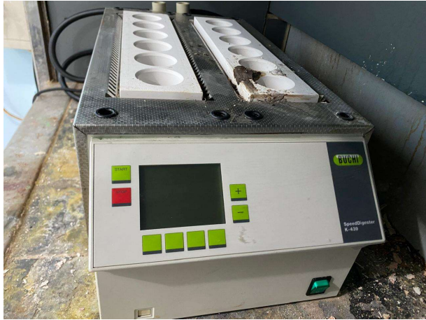
Gambar 3.15. Alat BUCHI untuk Destruksi Sampel
