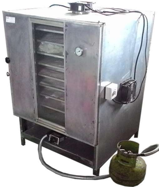
Gambar 3.14 Prototype Pengering Serbaguna Untuk Produk Pangan Skala IKM
