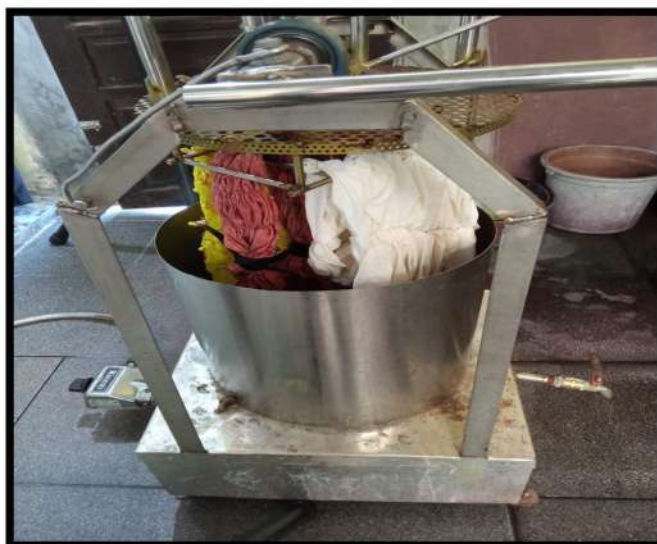
Gambar 3.2. Proses Pencelupan Kain Sasirangan Menggunakan hasil Rekayasa Baristand Industri Banjarbaru
