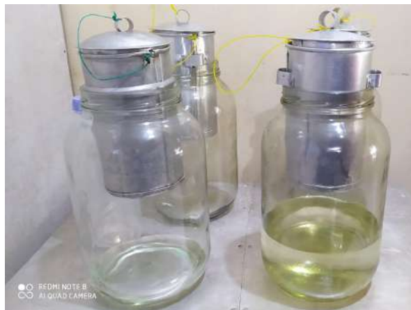
Gambar 3. Alat filtrasi yang dipakai IKM saat ini.
