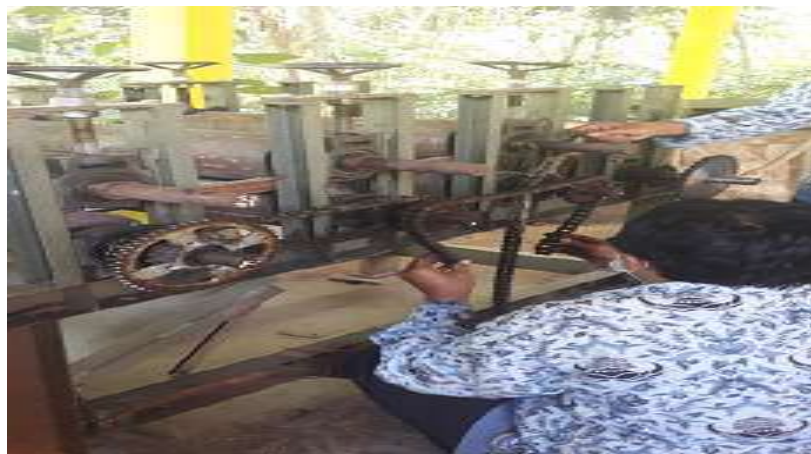
Instalasi Rantai Penggerak Antar Roda Gigi
