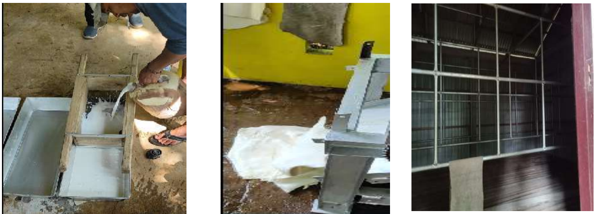
Gambar 3. Proses pengenceran dan penggumpalan , penggilingan dan pengasapan RSS
