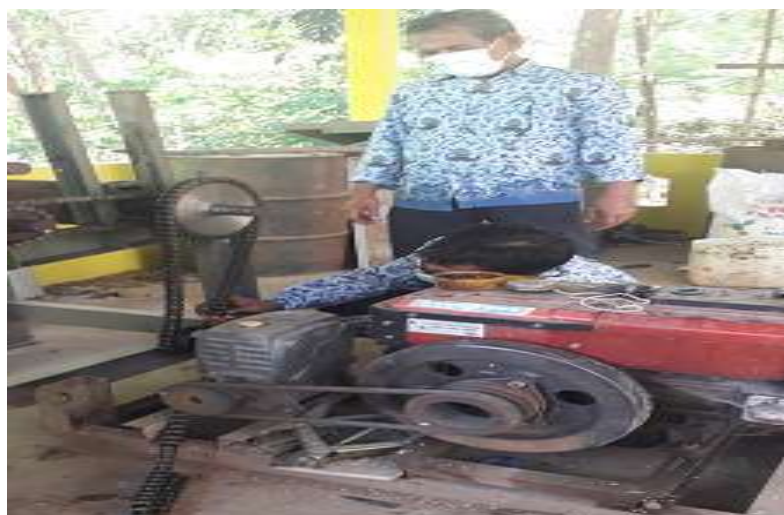
Instalasi Rantai Rooling Penggiling Sistem Penggerak
