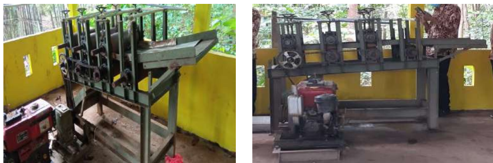
Gambar 1. Mesin penggiling RSS yang dipakai IKM sebelum DAPATI
