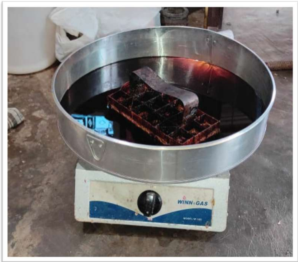
Gambar 4. Peralatan kompor dan loyang kue untuk memanaskan malam.
