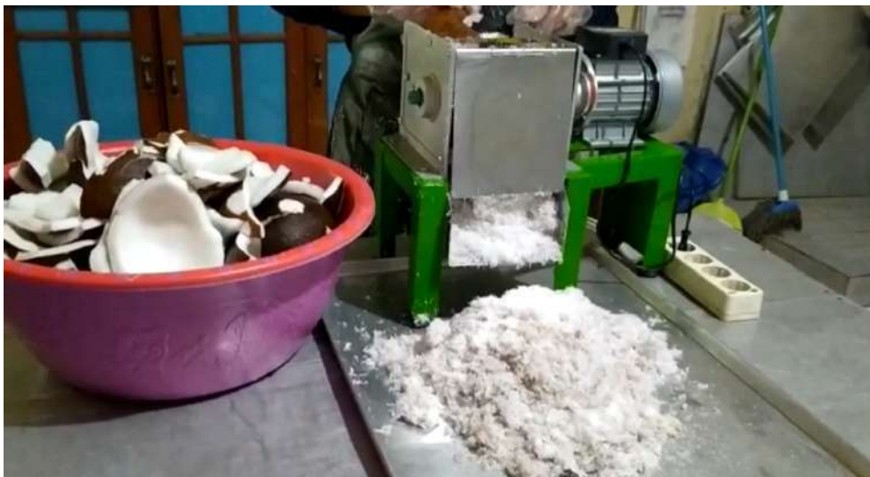
Gambar 9. Kelapa yang sudah dicuci diparut dengan mesin
