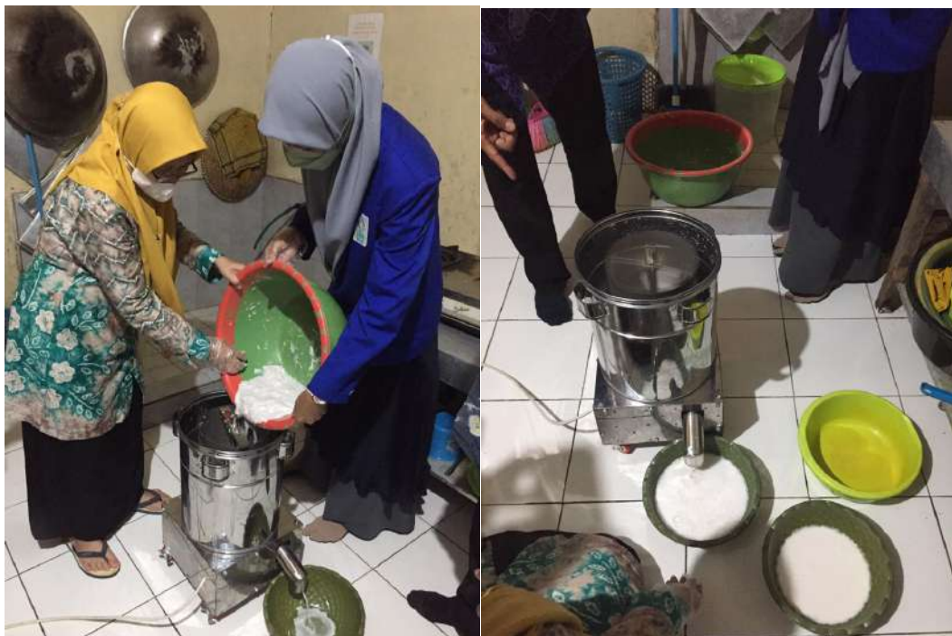
Gambar 22. Pemerasan santan dengan alat spinner
